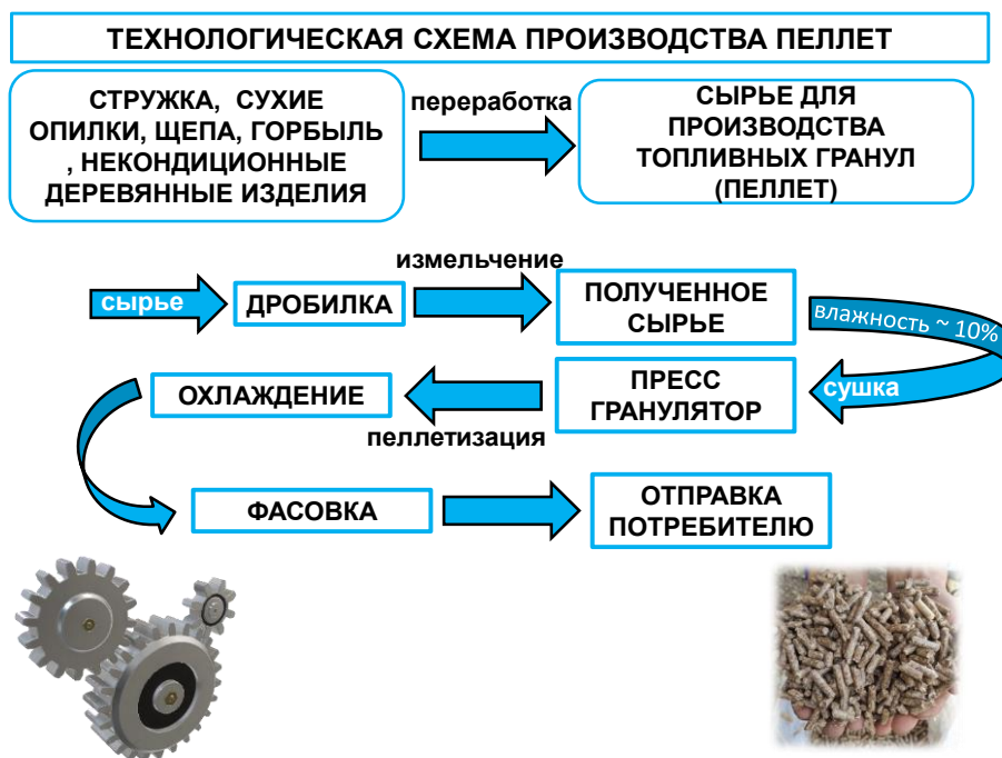
Рис. 16. Технологическая схема производства пеллет
