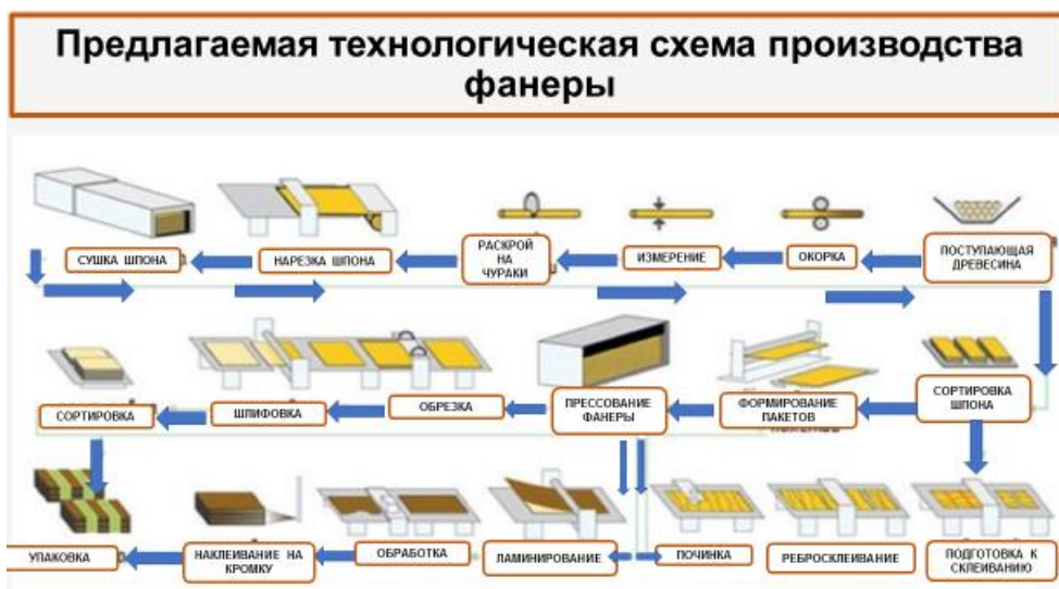
Рис. 7. Предлагаемая технологическая схема производства фанеры
