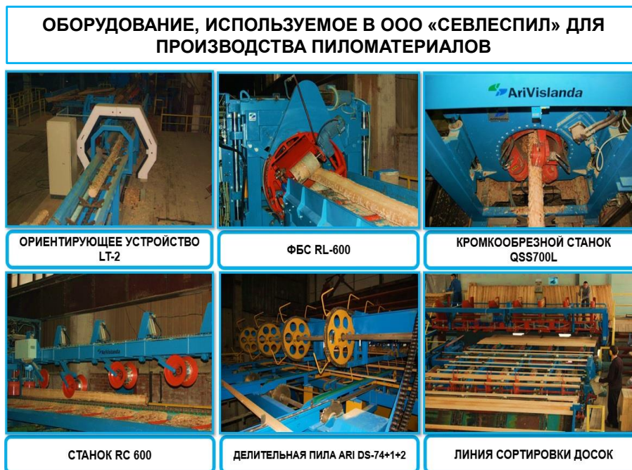
Рис. 3. Оборудование, используемое в ООО «СевЛесПил» для производства пиломатериалов
