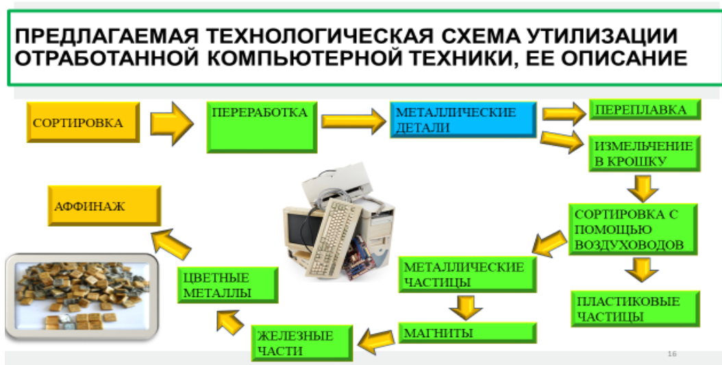
Рис. 12. Предлагаемая технологическая схема утилизации отработанной компьютерной техники
