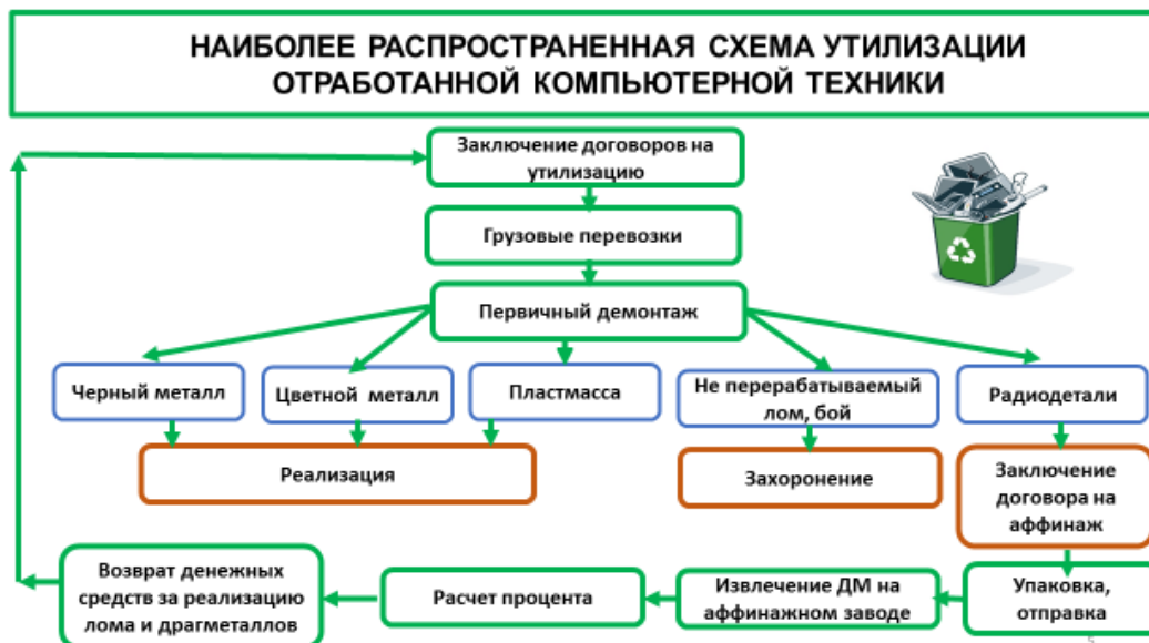
Рис. 4. Традиционная схема утилизации отработанной компьютерной техники
