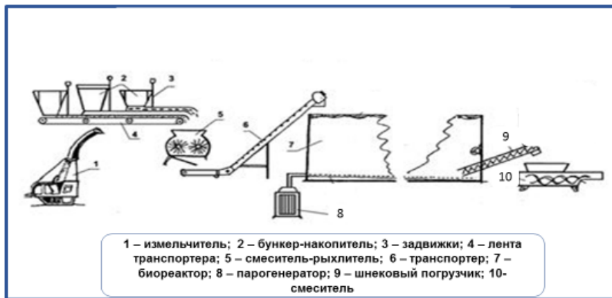
Рис. 8. Предлагаемая технологическая схема утилизации кородревесных отходов
